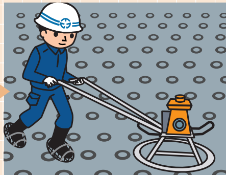
⑦ フローティング (機械ゴテによる不陸調整) (コーナー部分は木ゴテによる)
