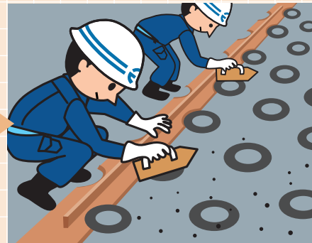
③ Oリング型(ゴム)埋込み (木ゴテによるゴム型押え、均し、)
